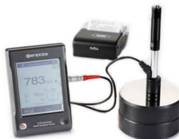
Fig. 2. Durómetro por el Método Leeb, modelo PO-EPX5500.
