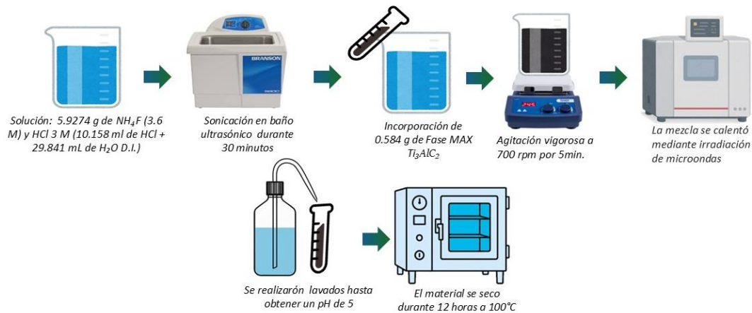
Fig. 2: Esquema representativo del procedimiento realizado para el grabado de la Fase MAX para obtener MXene multicapa.
