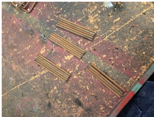
Fig.1. Varillas de hierro con un diámetro de 6 mm y longitud de 12.5 cm.
